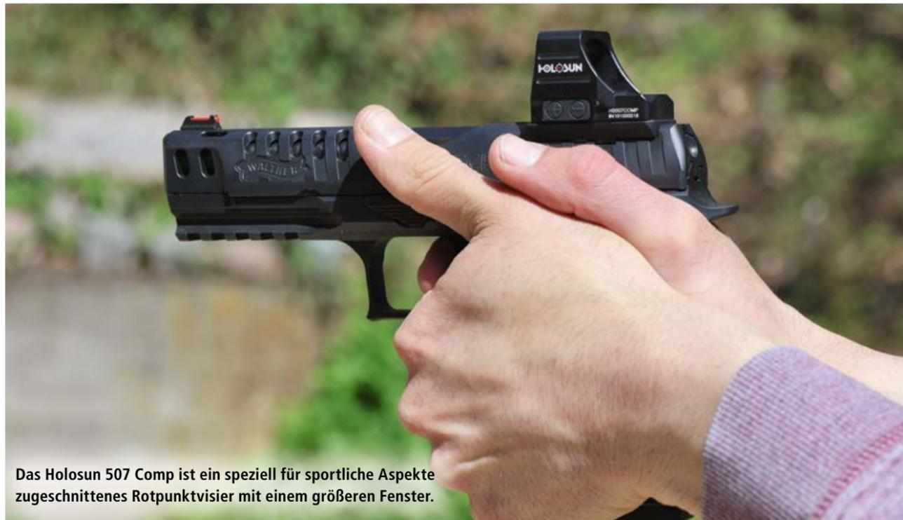
Das Holosun 507 Comp ist ein speziell für sportliche Aspekte zugeschnittenes Rotpunktvisier mit einem größeren Fenster.
