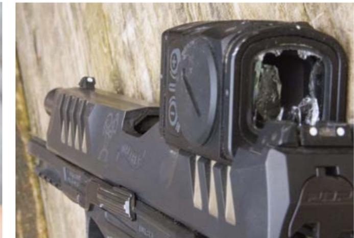
Im Rahmen eines Belastungstest wurde ein Aimpoint Acro C-2 mit Drop-Tests, Schlägen auf die Optik und Überfahren mit dem Auto an seine Grenzen gebracht. Selbst mit mehrfach gebrochenen Fenstern konnte weiterhin sicher geschossen werden. Selbst einen abschließenden Beschuss mit Schrot konnte die Technik zunächst wegstecken.
