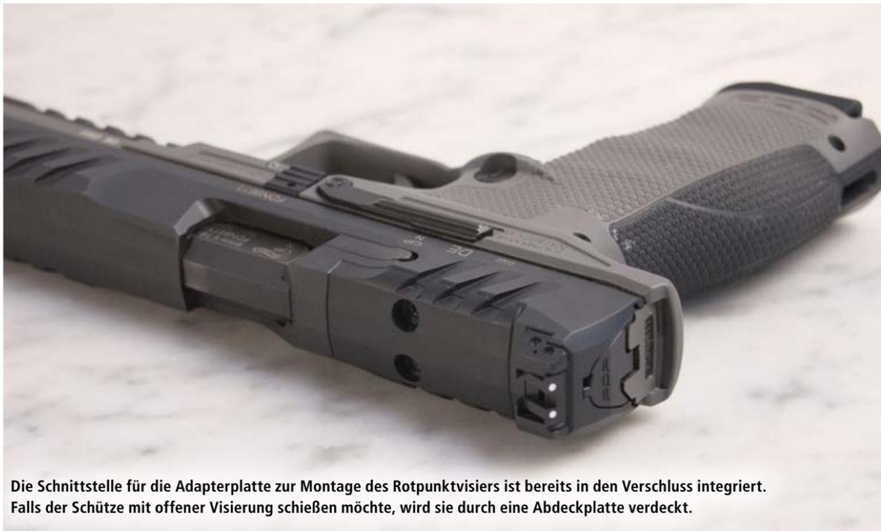
Die Schnittstelle für die Adapterplatte zur Montage des Rotpunktvisiers ist bereits in den Verschluss integriert. Falls der Schütze mit offener Visierung schießen möchte, wird sie durch eine Abdeckplatte verdeckt.
